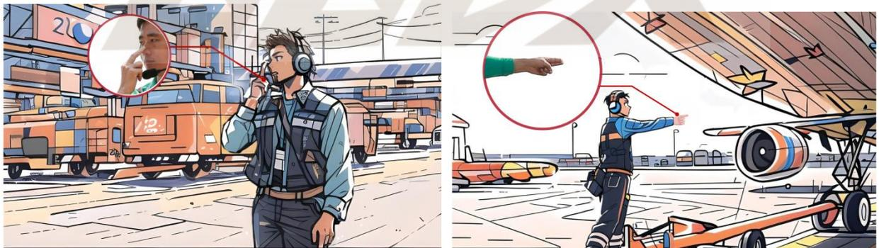
图 17 飞机推出方向确认
